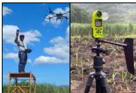
Imagen 7. Evaluación de condiciones ambientales y climáticas con anemómetro
