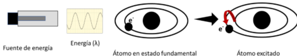
Figura N° 1. Proceso de absorción atómica (9)
