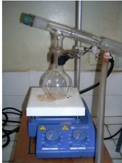
Figura C.3 Regulador con reóstato variable y agitador magnético
