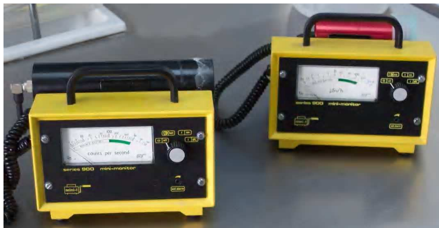
Figura 7.2.1 Minimonitores para detección de radiactividad.
