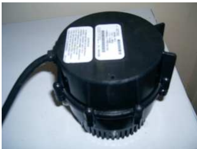
Figura C.2 Bomba para recirculación de Refrigerante
