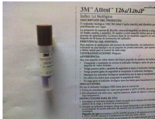
Fig. 28. Indicador biológico para calibración de autoclave.
