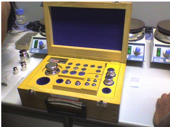
Fig. 27. Patrones de peso para calibración de balanzas.
