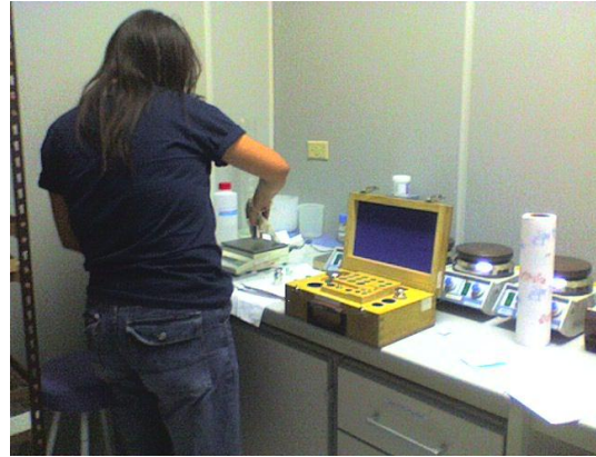
Fig. 26. Calibración de balanza granataria.
