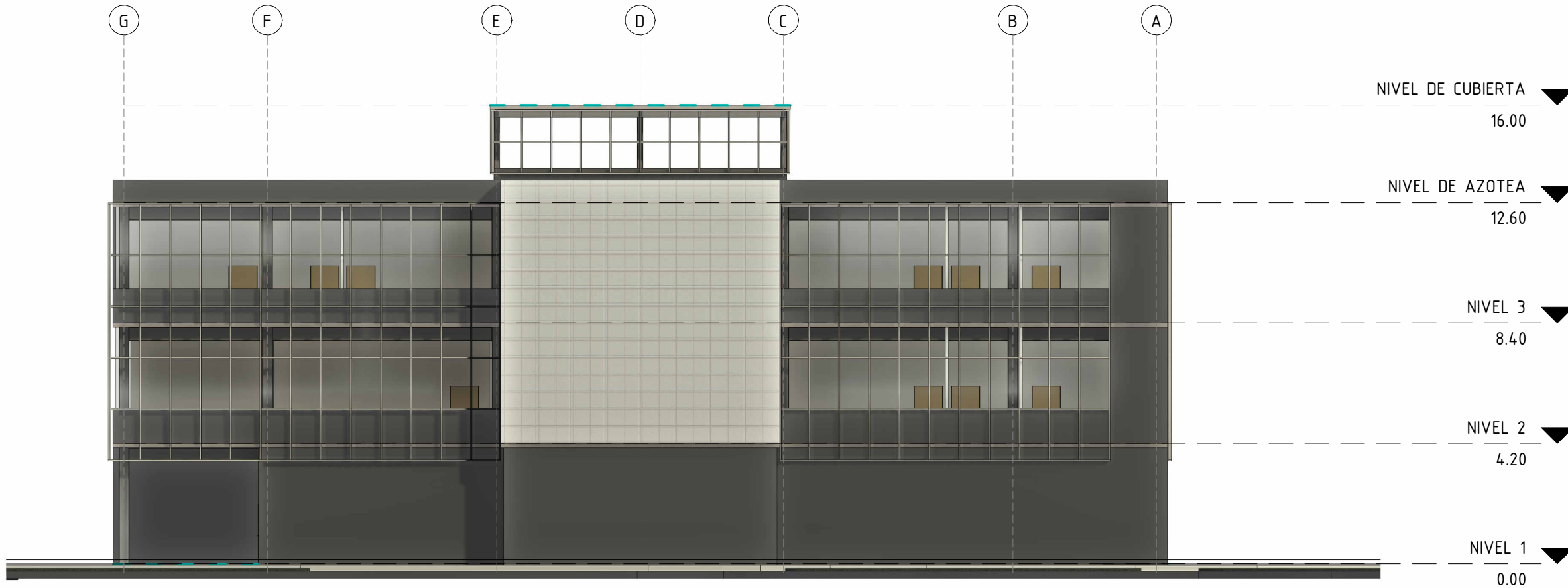
ELEVAC. 2 ELEVACION ORIENTE ESCALA 1 : 175
