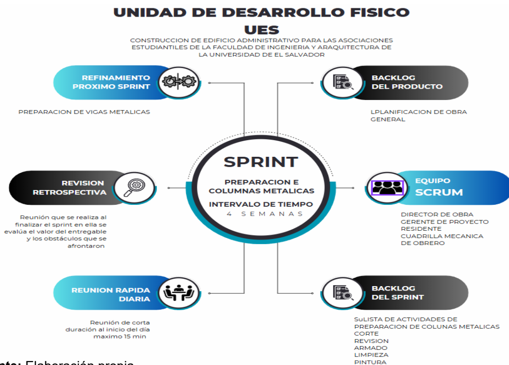
Ilustración 5: Estructura de sprint aplicado a la preparación de columnas metálicas
