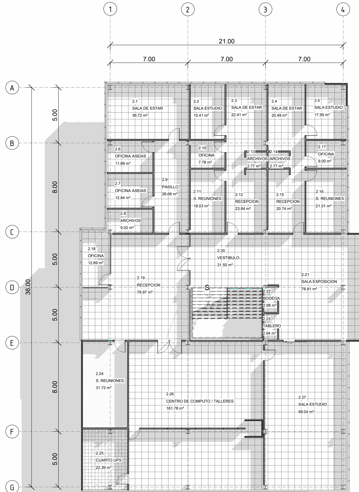
PLANTA 2 PLANTA ARQUITECTONICA NIVEL 2 ESCALA 1 : 200
