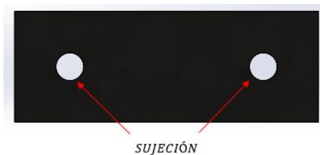
Figura 5-14: Esquema de sujeción del martillo. Fuente: SolidWorks Simulation.
