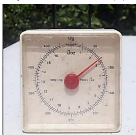
Figura 2-13: Balanza utilizada para medir la masa. Fuente propia.
