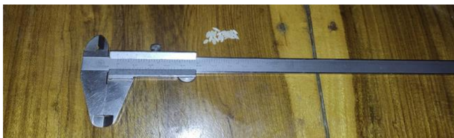
Figura 4-4: Pie de rey utilizado para medir el espesor de diez muestras de arroz.
