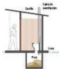
Ilustración 6 Letrina con sistema estático
