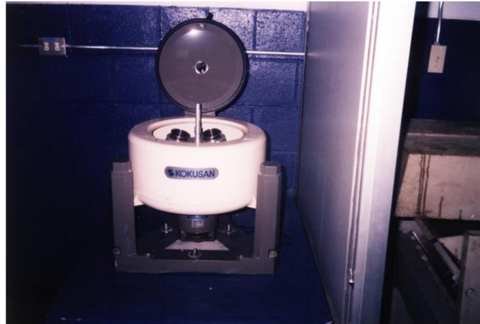
Ilustración 2.3-4 Aparato centrífugo, separa los agregados finos del asfalto-solvente. Marca: Fressia Macross.
