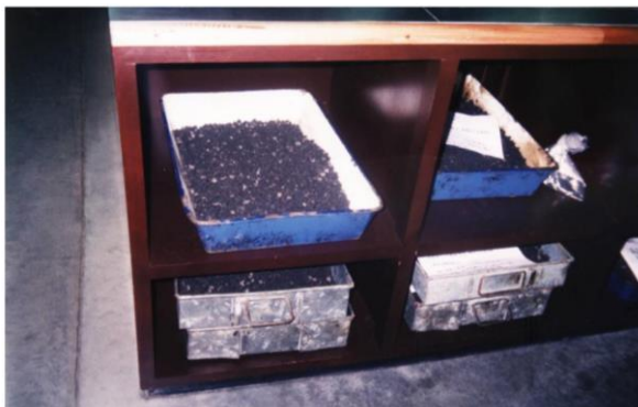
Ilustración 2.3-1 Muestra desmenuzada de agregados extraídos de un pavimento a reciclar.
