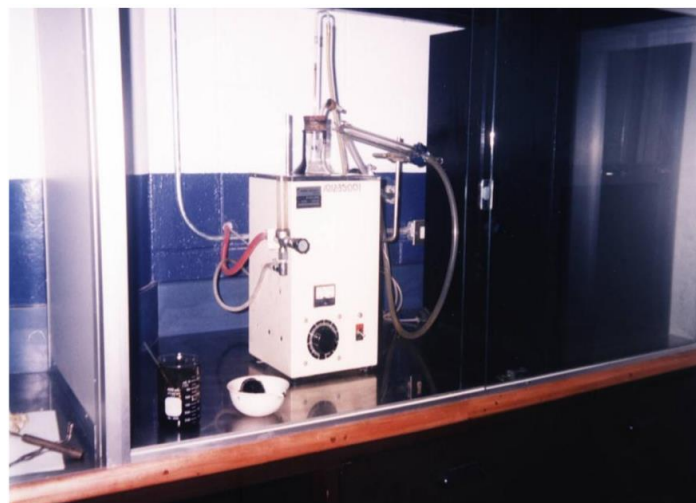
Ilustración 2.3-5 Equipo para extracción del asfalto, es decir separa el asfalto del solvente. Marca: Fressia Macross.
