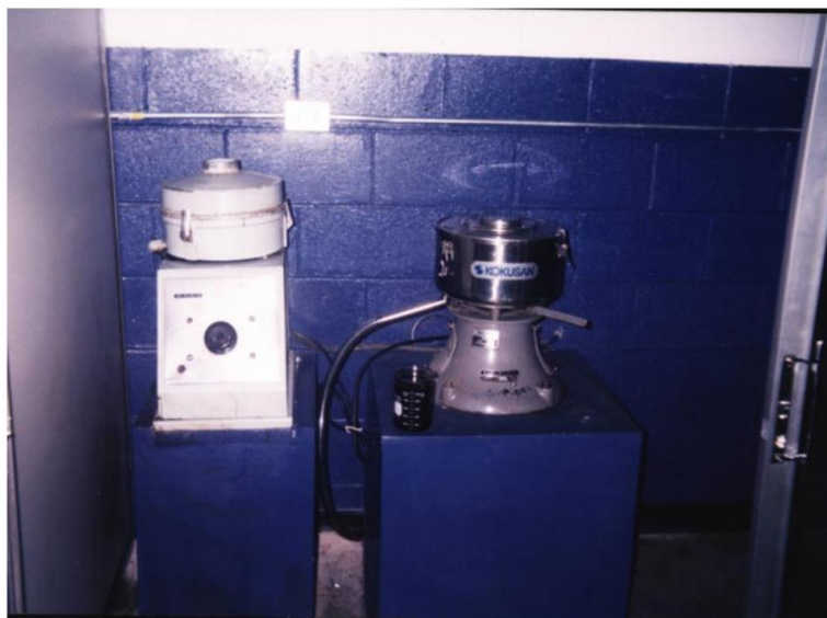
Ilustración 2.3-3 Extractores Centrífugos, separa los agregados del asfalto con solvente tricloroetileno. Marca: Soiltest, Inc. (izquierda) y Freesia Macross (derecha).
