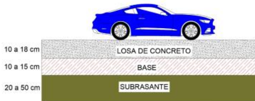
Ilustración 2.2-1 Estructura del Pavimento Rígido.
