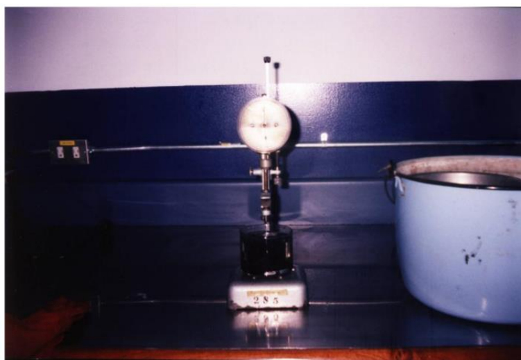
Ilustración 2.3-7 Equipo para determinar la Penetración del Asfalto. Normada por ASTM D 5 Marca: Soiltest, Inc.
