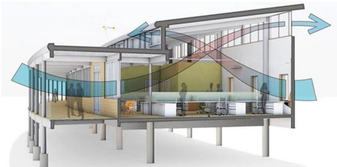
Figura 3 Flujo de aire en edificio con ventilación cruzada. Obtenido de (Baransu, 2025)
