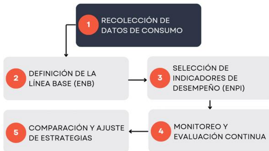
Figura 13 Diagrama de bloques. Obtenido de ISO 50006
