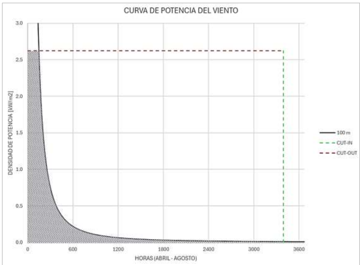
Figura 5.9 – Área bajo la curva de potencia del viento para 100 metros de altura, estimada desde abril a agosto.
