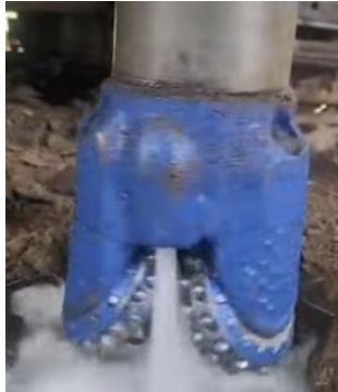
Figura 15. Proceso de expulsión de fluidos
