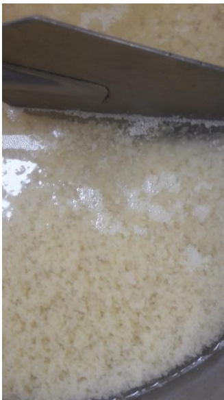
Figura A-14. Formación de floculos en el jugo de marañón.
