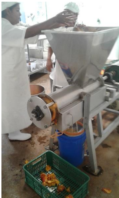
Figura A-8. Extracción del jugo del falso fruto.
