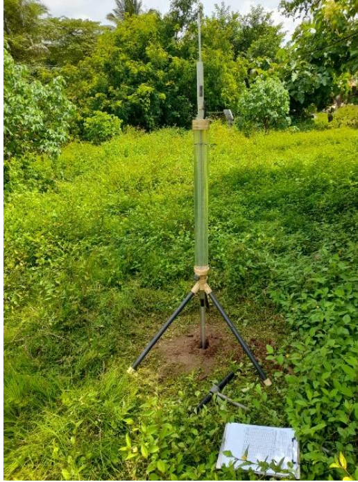
Figura 2.6. Toma de datos de infiltración y la configuración del permeámetro de Guelph en campo.
