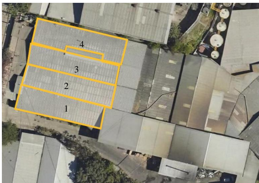
Ilustración 40. Secciones de techo aptas para instalación de paneles solares. Fuente: elaboración propia.
