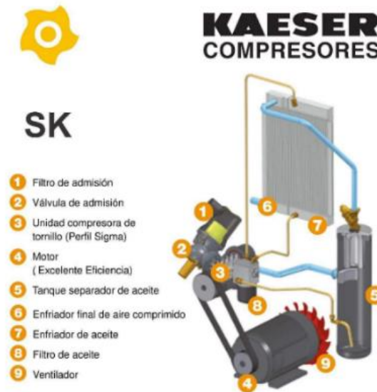
Ilustración 21. Esquema de funcionamiento y partes de un compresor Kaeser serie SK. Fuente: Kaeser Compresores
