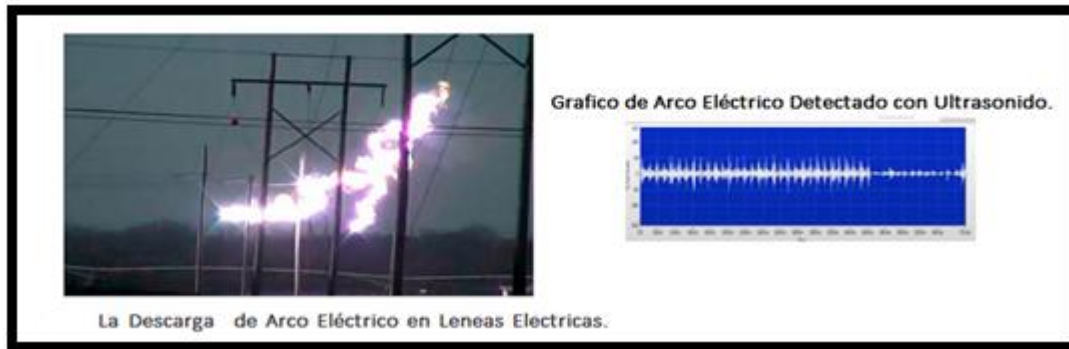
Fig. 5.3.6 Descargas de Arco Eléctrico y su Grafico Detectado con Ultrasonido Acústico.
