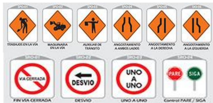
Esquema 9: Señales que posiblemente se utilicen para la canalización del tráfico vehicular en las inmediaciones el proyecto.
