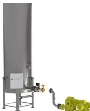
Figura 34. Antorcha HE y HTE de llama baja, cámara de combustión con aislamiento multicapa, encendedor de electrodo y sensor UV para detección de llama continua. Fuente: https://www.progecosrl.com/es/antorcha-de-llama-oculta.html
