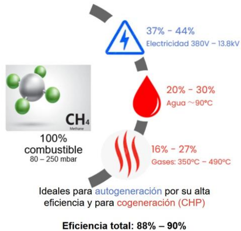
Figura 36. Parámetros estimados para cogeneración considerando la eficiencia en la transformación del biogás (Elaboración propia)
