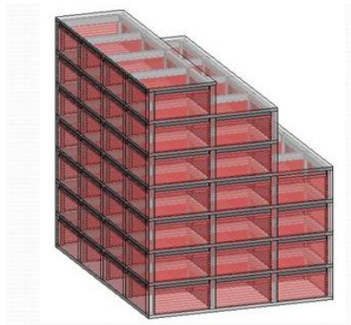
Figura IV- 6 Irregularidad geométrica vertical
