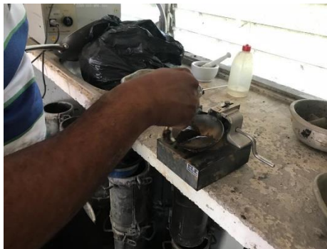
Figura V-8 ensayo de Casa Grande
