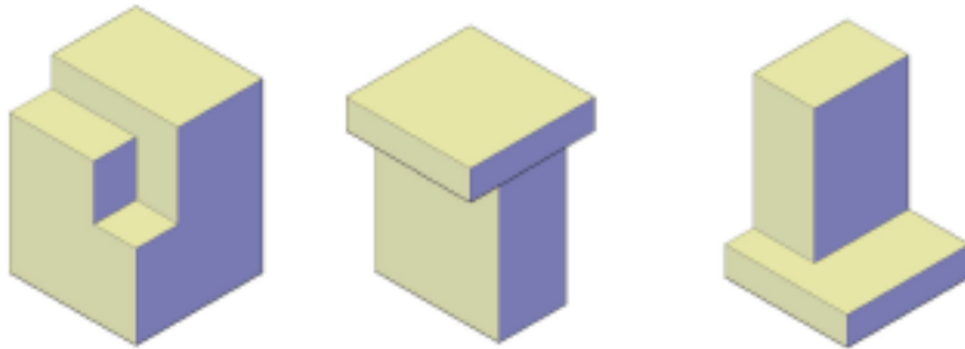
Figura IV-2: Irregularidad en elevación: Cambio abrupto en la geometría.
