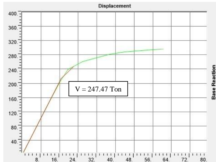
Figura VI-72: Cortante basal en el punto de desempeño (Patrón de carga basado en la NTDS).
