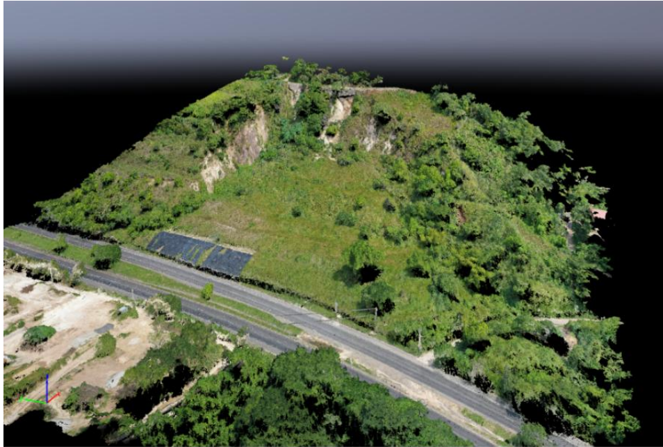
Figura 6-35. Resultado final del procesamiento en el que se presente la ladera inestable total.
