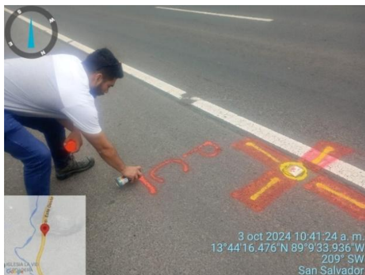
Figura 5-5: Marca foto identificable para el cálculo del PCF con RTK NTRIP.
