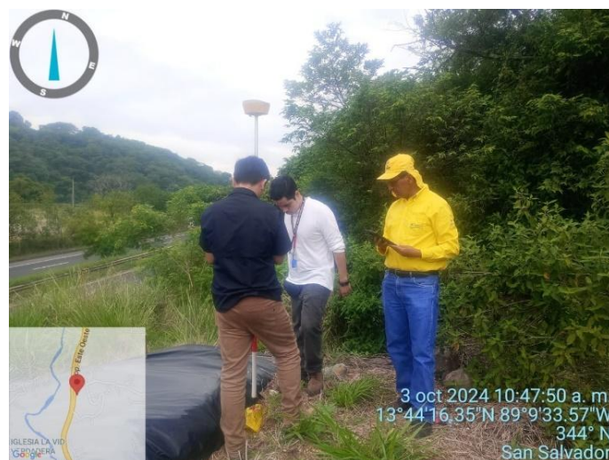
Figura 5-6. Geolocalización de los PCF con RTK NTRIP.
