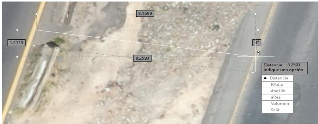
Figura 6-72. Longitud de carriles de la carretera sobre el ortomosaico en el que se muestra la calidad de los resultados.
