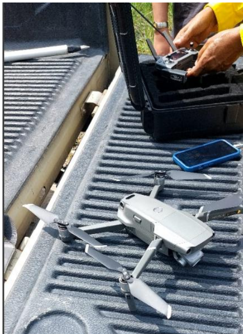
Figura 5-7. Fotografía de dron utilizado en la medición de la zona de estudio de la ladera.
