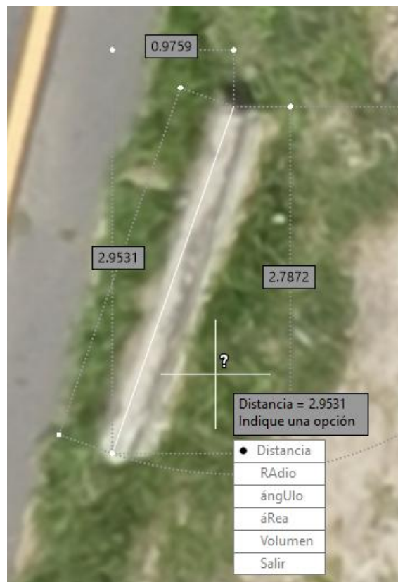
Figura 6-73. Verificación de longitud sobre el ortomosaico que muestra la calidad de los resultados.
