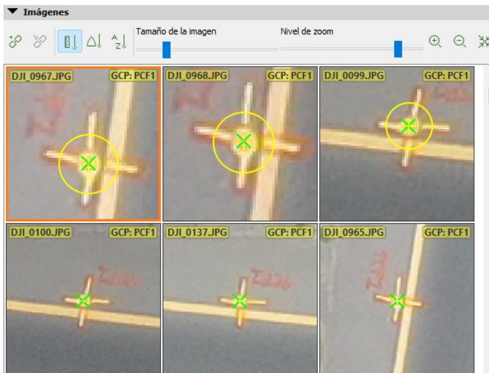
Figura 6-23. Colocación de coordenadas para PCF 1 en diferentes fotografías aéreas pertenecientes al dron.
