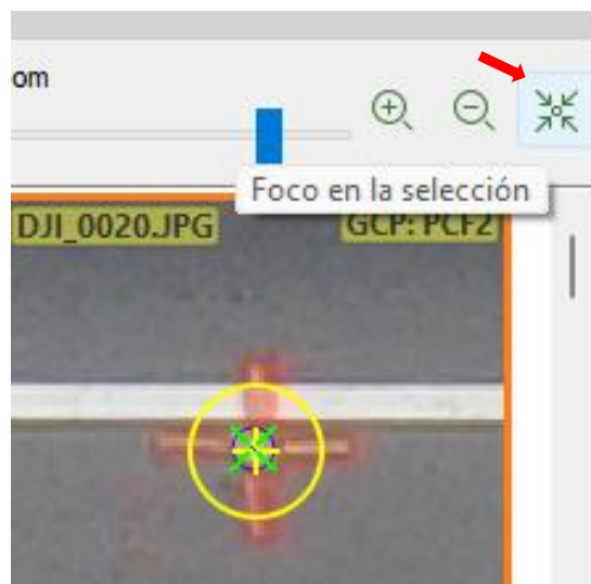
Figura 6-21. Se muestra la apariencia del icono “Foco en la selección” en PIX4DMAPPER.
