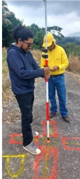
Figura 5-3. Posicionamiento y nivelación de equipo GPS de doble frecuencia para la toma de puntos PCF con la técnica RTK NTRIP.
