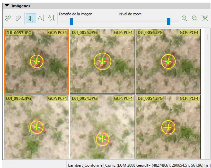
Figura 6-24. Colocación de coordenadas para "PCF 4" en diferentes fotografías aéreas pertenecientes al dron.
