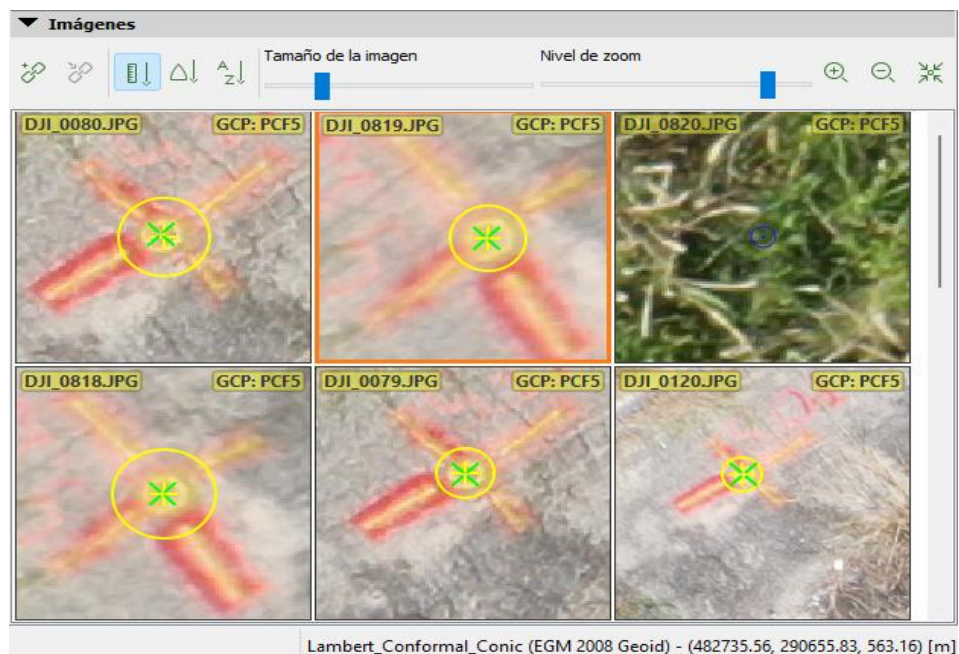
Figura 6.25. Colocación de coordenadas para PCF 5 en diferentes tomas aéreas Fuente. Elaboración propia
