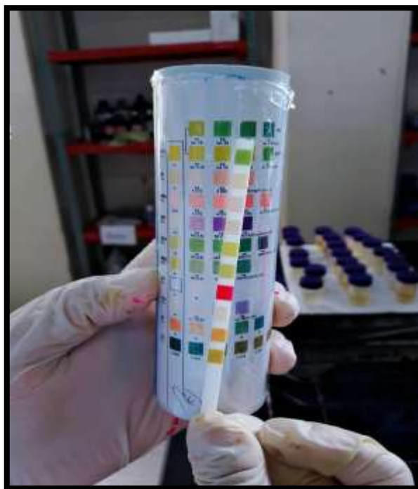
Figura 20: Lectura de la tira reactiva con la escala de colores que contiene el frasco.
