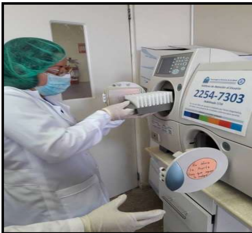
Figura 29: Introducción del Cassette al equipo VITEK 2 para el proceso de aspiración, llenado e identificación bacteriana.
