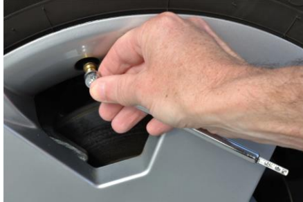
Ilustración 8 Colocación de manómetro durante proceso de medición
