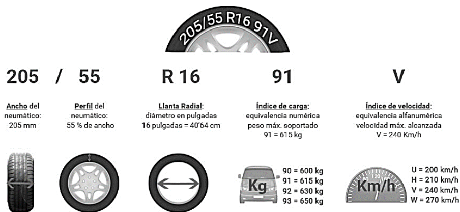
Figura 11. Dimensiones de neumático.
