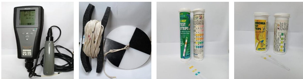
Figura 30. Equipo e instrumentos utilizados para realizar toma de parámetros físicoquímicos del agua.
