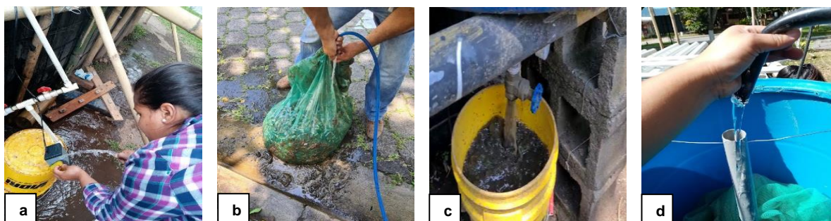
Figura 29. Actividades mensuales: a) limpieza de bombas de recirculación de agua, b) limpieza de material filtrante; c) drenaje de biofiltros; d) limpieza de biofiltros.
