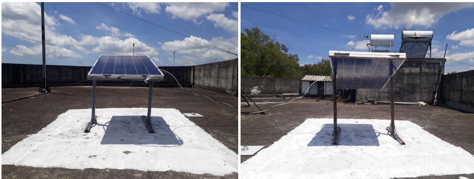
Figura 71. Foto de la superficie de concreto pintado de blanco a la altura de 1m.
