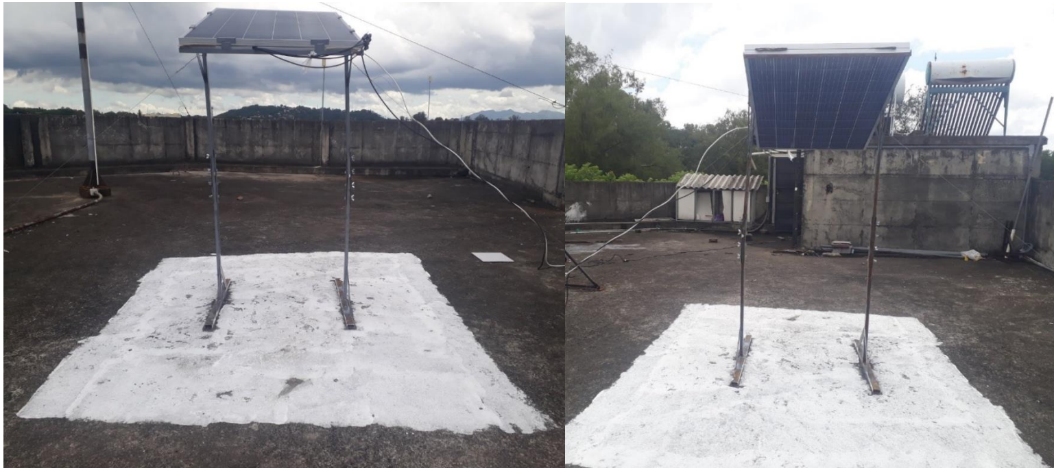
Figura 72. Foto de la superficie de concreto pintado de blanco a la altura de 2m.
