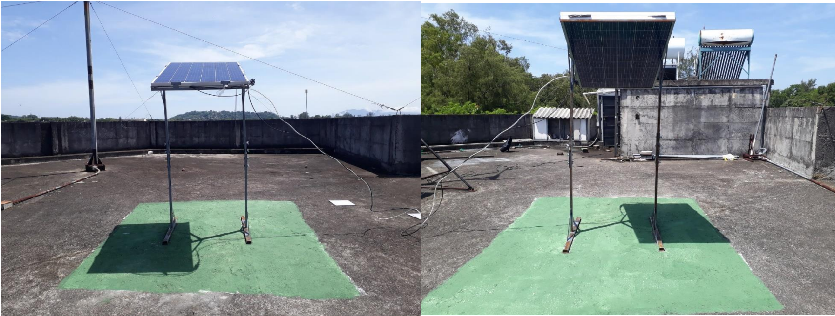
Figura 73. Foto de la superficie de concreto pintado de verde a la altura de 2m.
