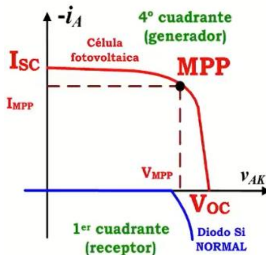
Figura 6. Curva de tensión corriente de una célula fotovoltaica.
