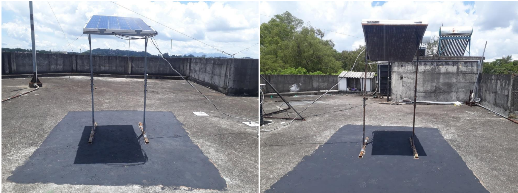
Figura 77. Foto de la superficie de concreto pintado de negro a la altura de 2m.
