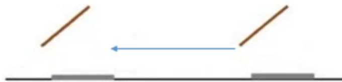
Figura 58. A mayor distancia los arreglos de paneles se tiene mayor reflexión.
