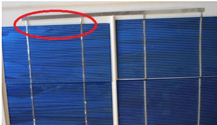
Figura 17. Cintas que conectan las celdas fotovoltaicas llamadas bus bar.
