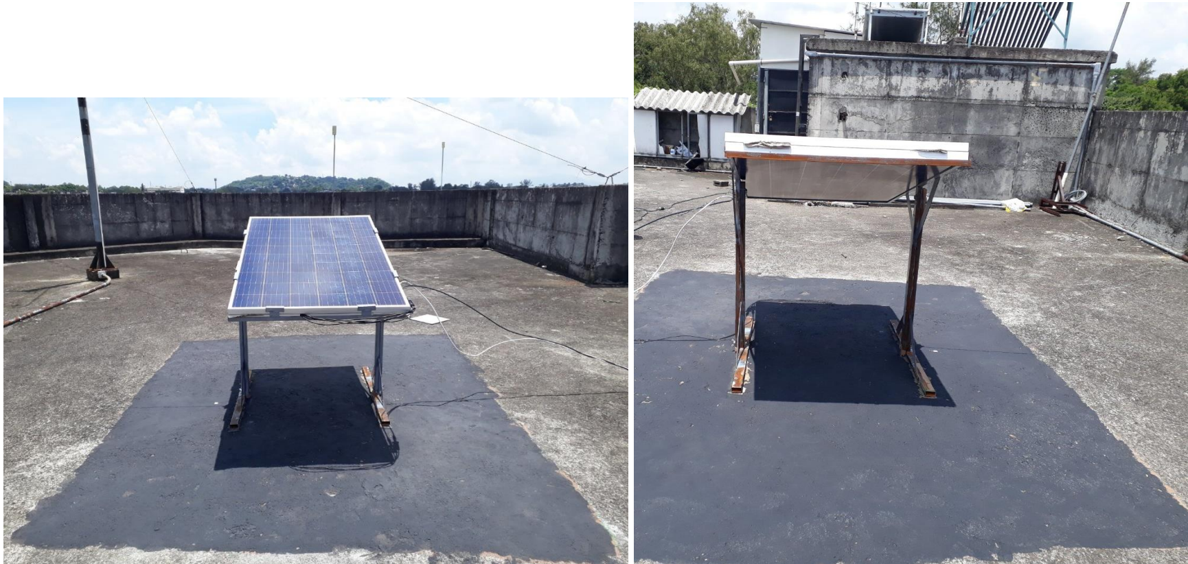
Figura 78. Foto de la superficie de concreto pintado de negro a la altura de 1m.
