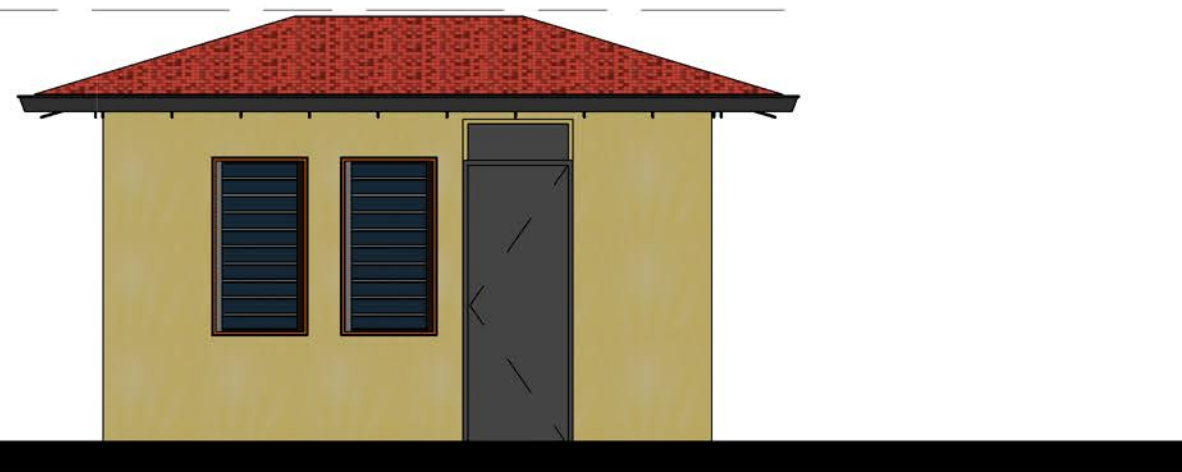
Elevación Lateral Caseta de Vigilancia Terranova 1:50
