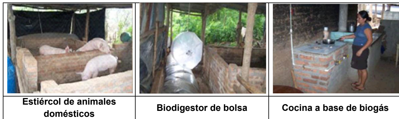
Figura 7.4: Sistema de biodigestor y cocina a base de biogás.
