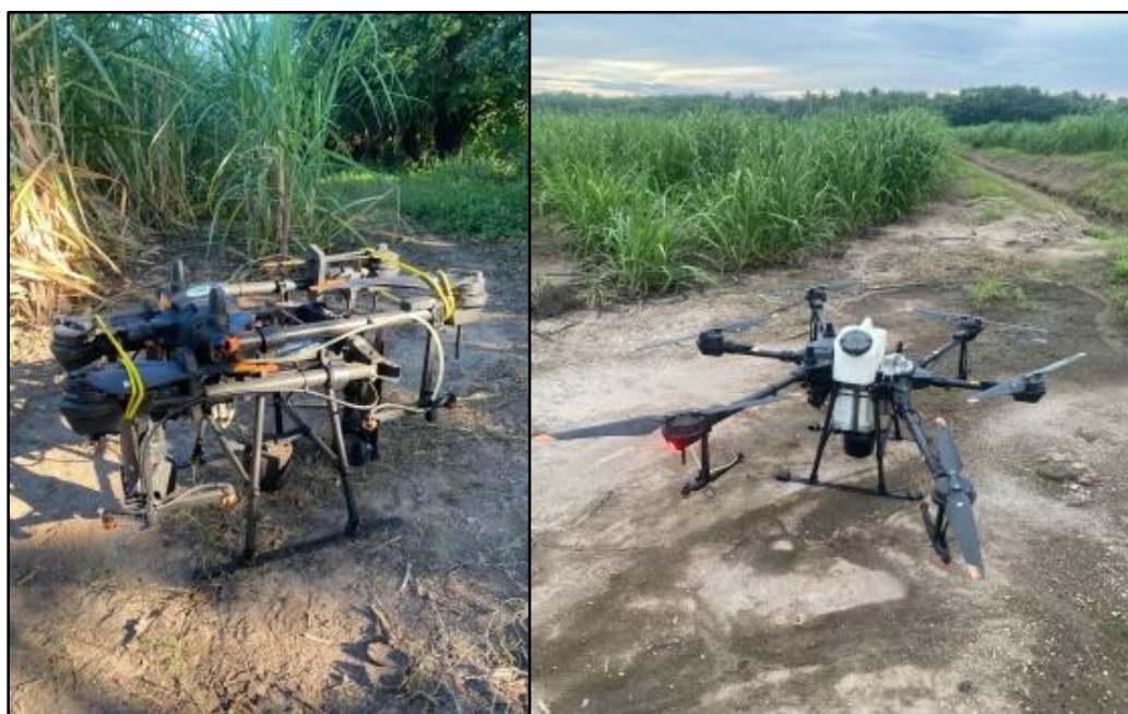
Imagen 8. VANT DJI T20 listo para desplegar brazos y armar hélices.
