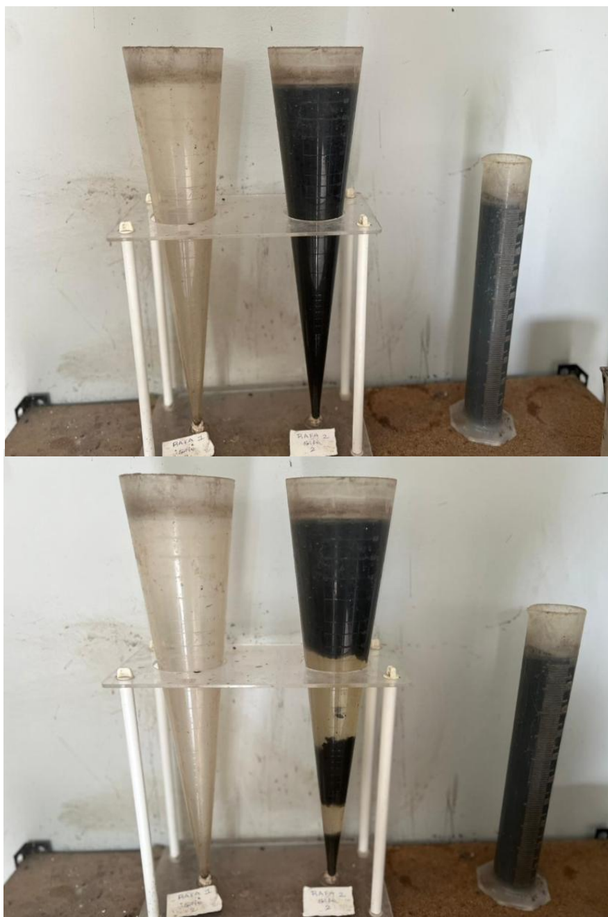
Figura N°1. Evaluación de sólidos sedimentables mediante cono Imhoff Fuente: Elaboración propia
