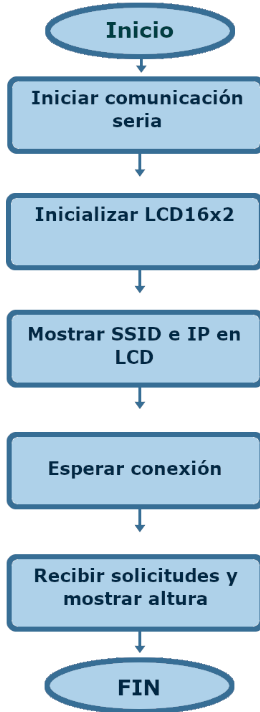
Figura 20: Diagrama de flujo del proceso de la ESP32. Fuente. Elaboración propia.
