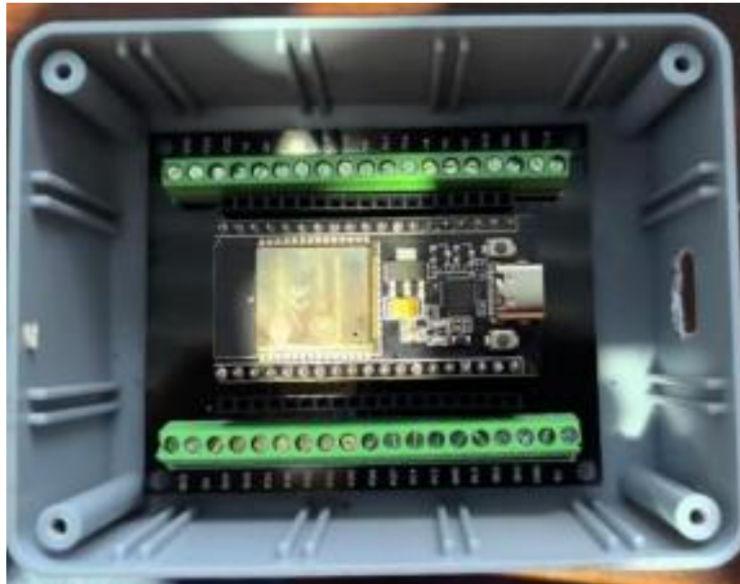
Figura 22: Instalación esp32 y tarjeta de expansión en una caja de proyectos Steren. Fuente. elaboración propia.
