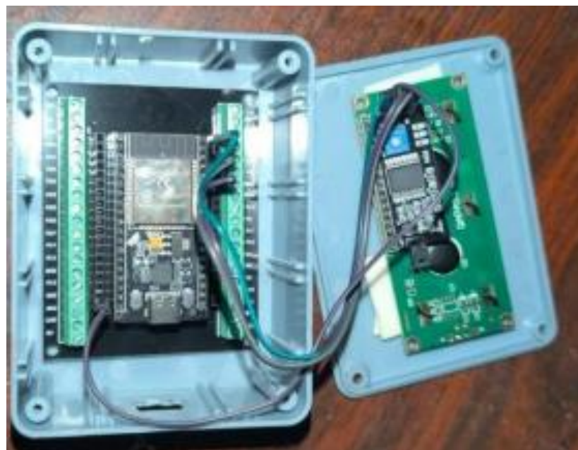
Figura 23: Instalación LCD y conexión con ESP32. Fuente. Elaboración propia.
