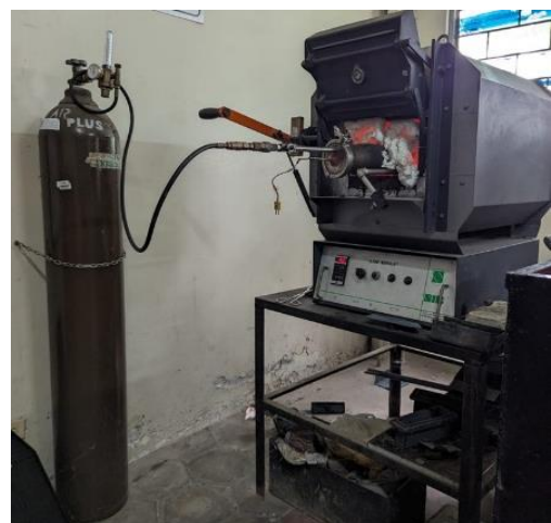
Fig. 2.12. Cilindro de argón y horno utilizados para los tratamientos térmicos.
