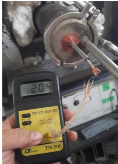
Fig. 2.14. Temperatura de revenido para las espigas de acero SAE O1.
