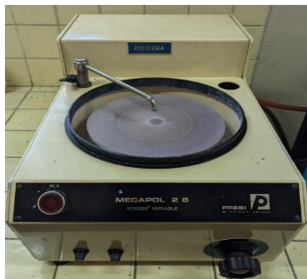
Fig. 2.23. Máquina pulidora para realizar el pulido de espejo.
