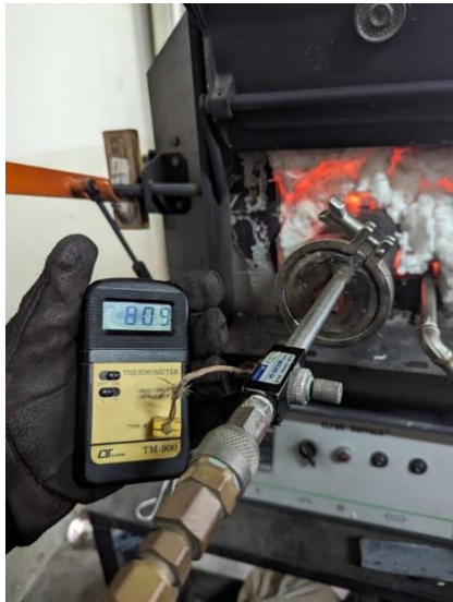
Fig. 2.13. Temperatura de temple para las espigas de acero SAE O1.
