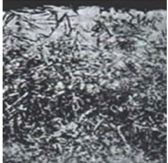
Fig. 1.13. Capa periférica de una pieza cementada y templada de un acero Cromo-Níquel, 200x [3].
