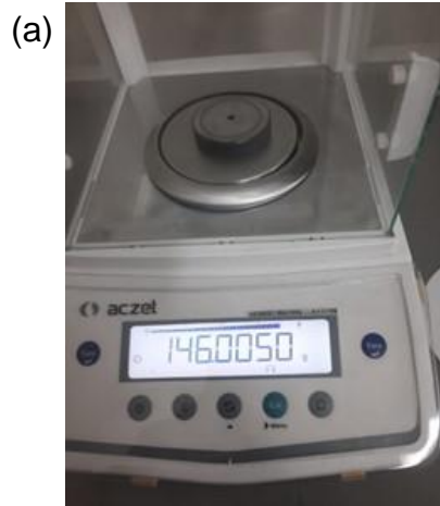
Fig. 2.19. Pesaje en una balanza semi-analítica disco y espiga: a) Peso final de disco; y b) Peso final de espiga.
