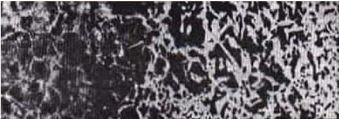
Fig. 1.8. Microestructura de la capa cementada en el acero, 200x [1].
