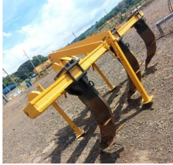
Figura 10. Implemento subsuelo con tres puntas (servicio prestado hacia los productores por la Compañía Azucarera salvadoreña S.A de C.V)
