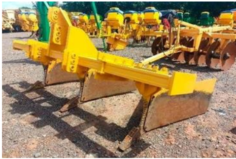
Figura 20: Implemento subsuelo, utilizado para hacer una rotura de 50 a 60 cm de profundidad.
