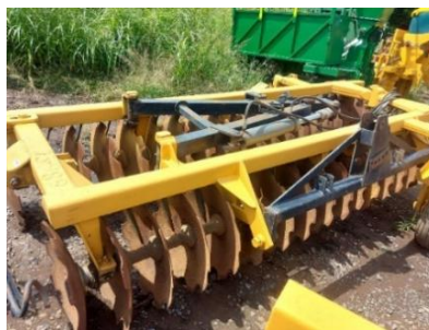
Figura 8. Implemento rastra liviana (servicio prestado hacia los productores por la Compañía Azucarera salvadoreña S.A de C.V)
