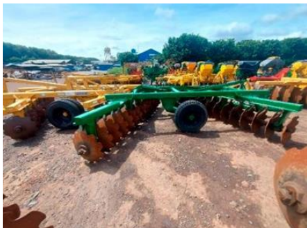
Figura 19: Rastra rompedora de 16 discos de 36 pulgadas para realizar la rotura del suelo.
