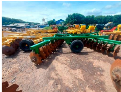
Figura 7. Rastra rompedora pesada con disco de 36 pulgadas (servicio prestado hacia los productores por la Compañía Azucarera salvadoreña S.A de C.V)
