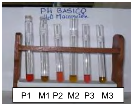
Fig. 86 Identificación de Antocianinas con un pH alcalino en extractos de Mora, Fresa y Uva en Agua destilada por Maceración.
