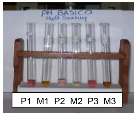
Fig. 82 Identificación de Antocianinas con un pH alcalino en extractos de Mora, Fresa y Uva en Agua destilada por Método Soxhlet.
