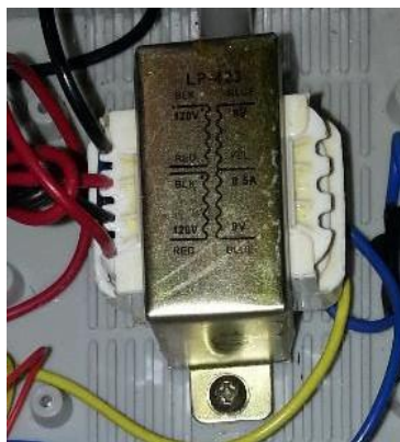
Figura 18: Transformador de voltaje monofásico LP-423. 120/9V, 120/18V, 240/9V, 240/18V.
