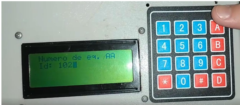
Figura 41: Pantalla para configurar el número de identificación del AA a medir.
