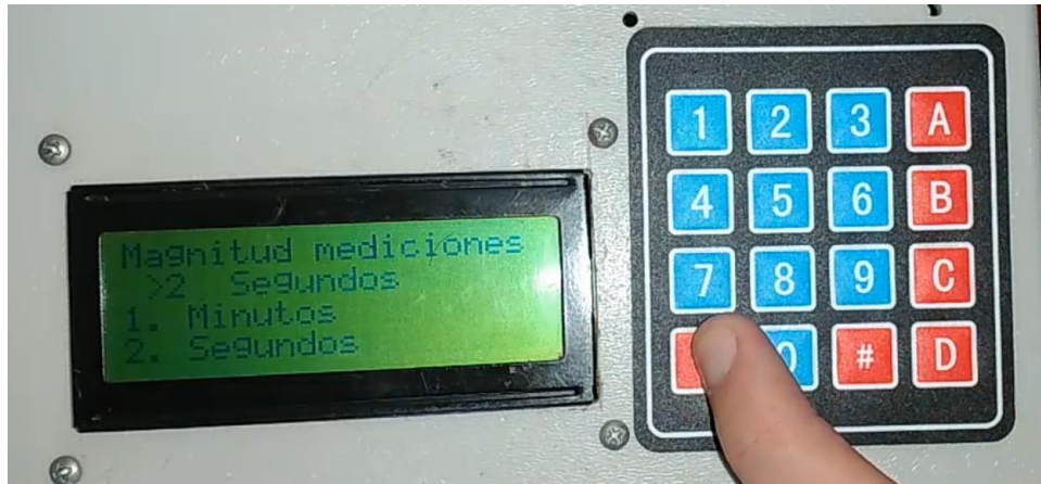
Figura 44: Pantalla para configurar la unidad de tiempo para el intervalo de mediciones.
