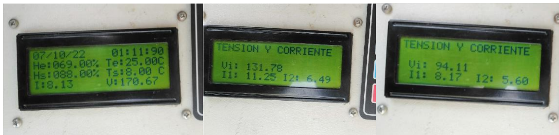
Figura 51: Fotografías vistas desde el Analizador para las lecturas de voltaje, corriente, temperatura y humedad.
