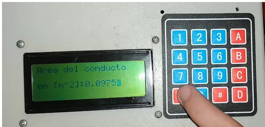
Figura 43 Pantalla para configurar el área del conducto de ventilación del aire acondicionado.
