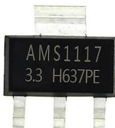
Figura A.20. AMS1117, regulador LDO de 3.3V.
