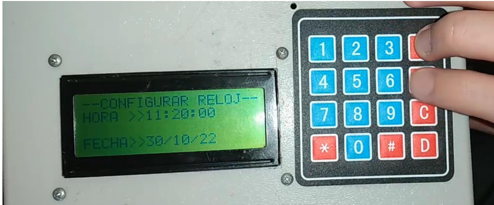
Figura 40: Pantalla para configurar la hora y fecha del Analizador EER.
