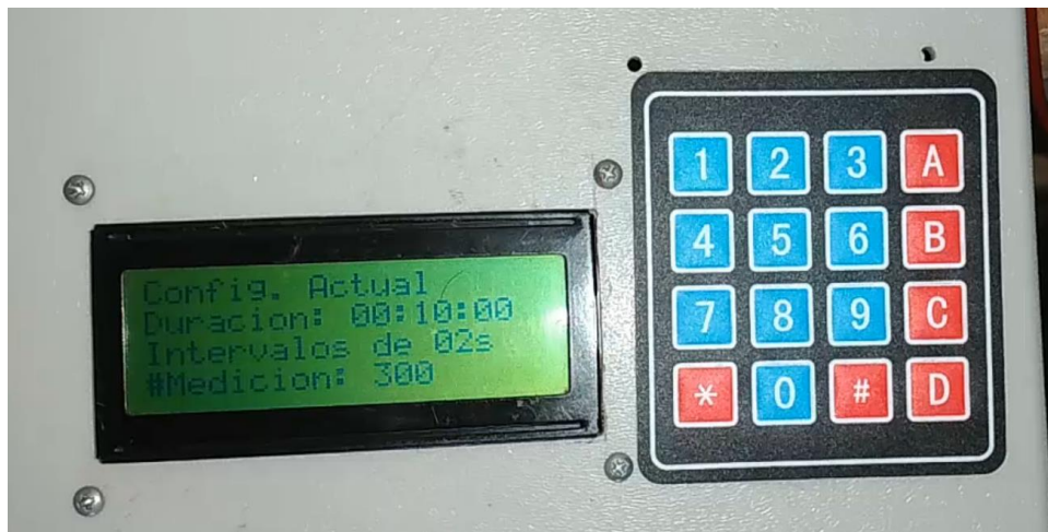
Figura 46: Pantalla para observar las configuraciones aplicadas para los intervalos de medición.
