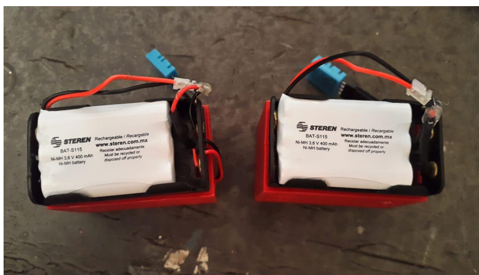
Figura A.21 Módulos sensores con el nuevo diseño de baterías utilizado
