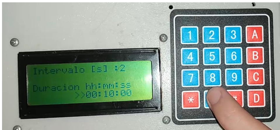
Figura 45: Pantalla para configurar la duración de los intervalos de medición y la duración del periodo de medición.
