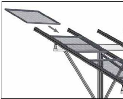
Fig. 3.13. Colocación de los módulos fotovoltaicos
