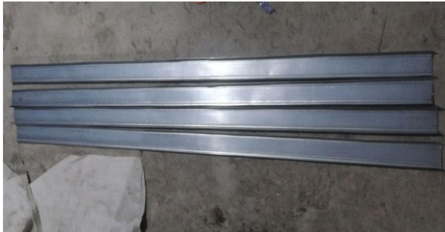
Figura 14. Perfil de tabla roca para la construcción del prototipo.
