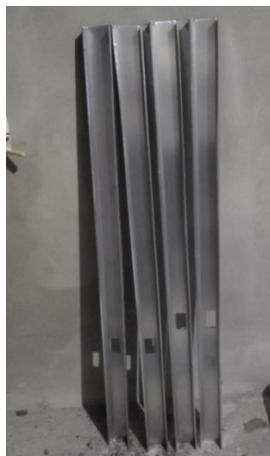
Figura 13. Postes de tabla roca para la construcción del prototipo.
