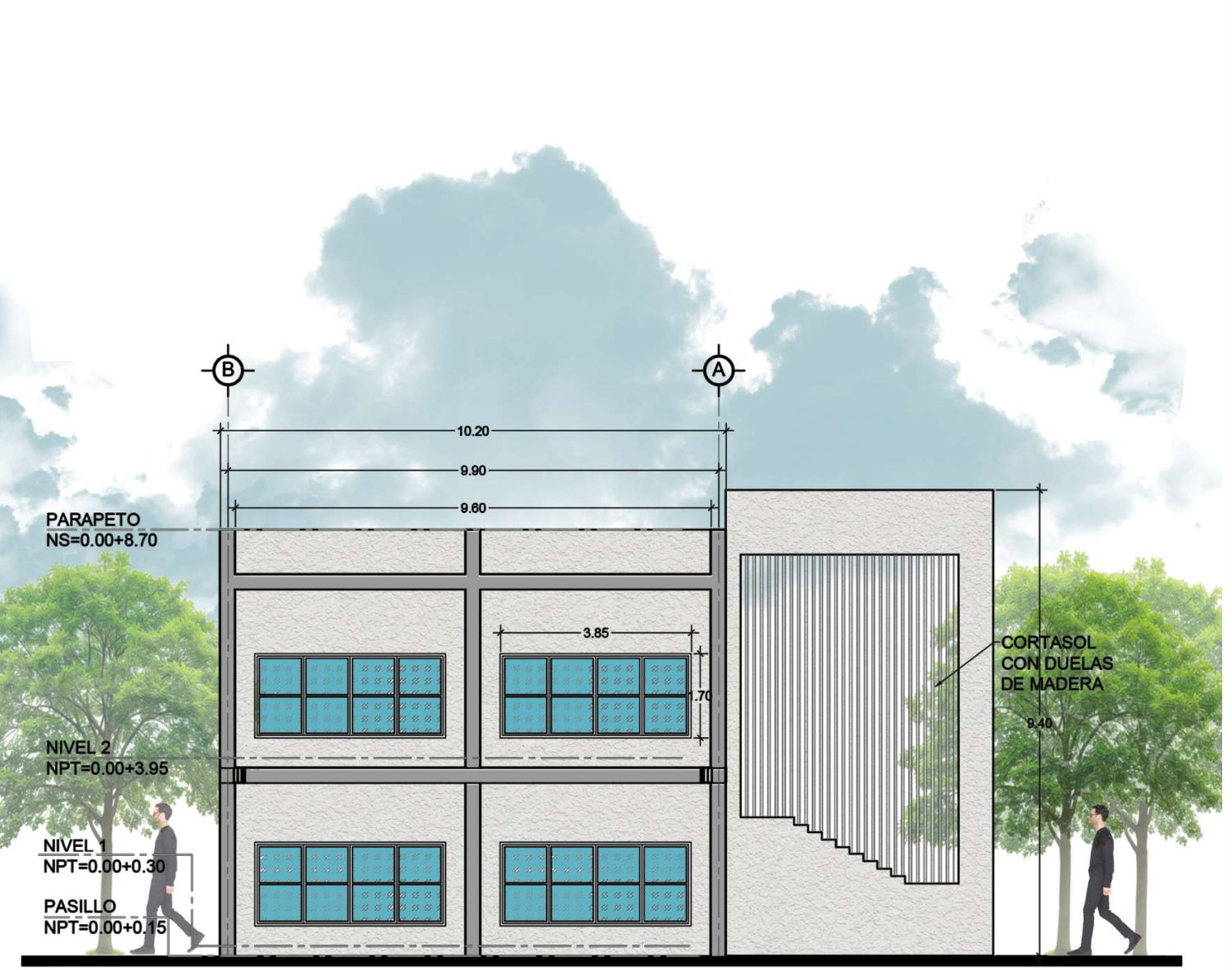
FACHADA POSTERIOR - EDIFICIO DE AULAS ESC 1:125
