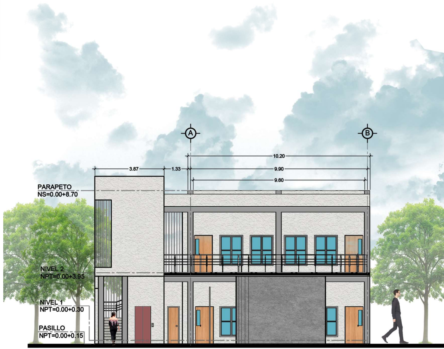
FACHADA FRONTAL - EDIFICIO DE AULAS ESC 1:125
