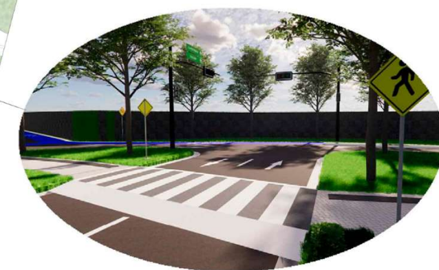
TÚMULO CON PASO PEATONAL
