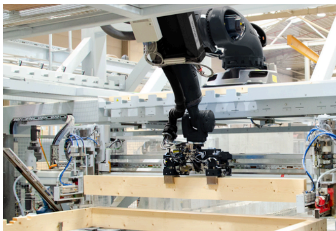
Figura 4. Línea de producción automatizada de módulos de vivienda de madera prefabricados en la fábrica de Lindbäcks Bygg (Piteå, Suecia). Fuente: HOMAG / Lindbäcks Bygg
