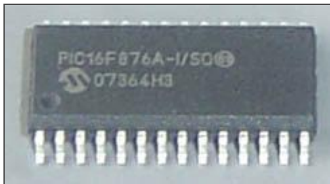
Figura 3.5 : PIC16F876A encapsulado tipo SOIC.
