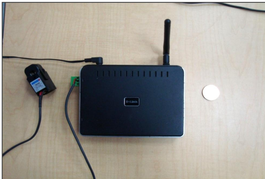
Figura 3.21 : Medidor Inalámbrico de Consumo de Energía Eléctrica de Bajo Costo.
