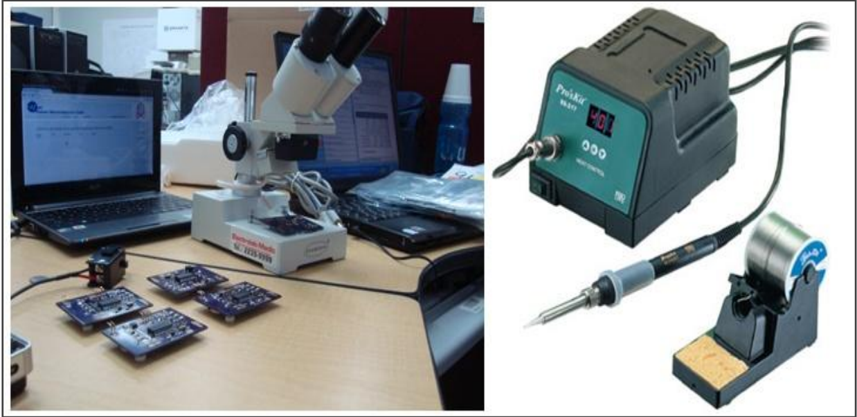
Figura 3.15 : (a) Microscopio; (b) estación de soldadura necesaria para poder realizar la soldadura de los componentes SMD.
