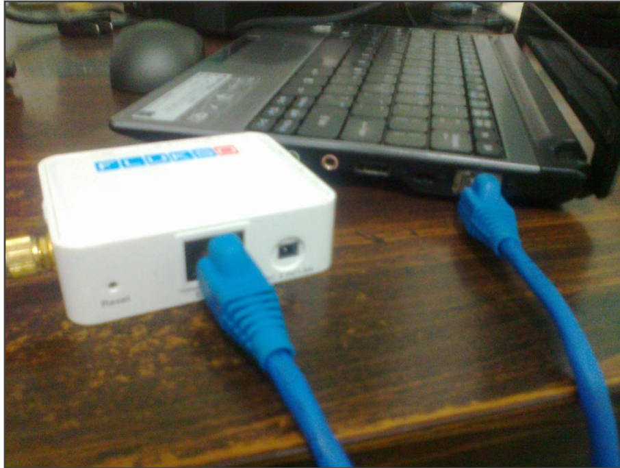
Figura 2.11 : conexión del medidor Flukso con la PC.
