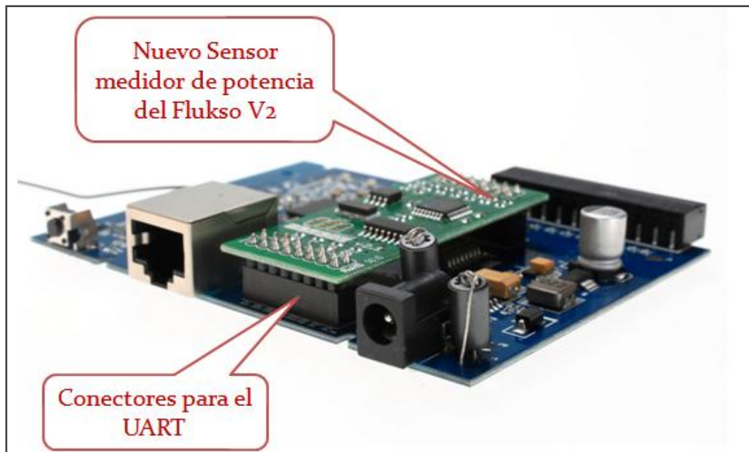
Figura 6.3: circuitos del router Dragino.
