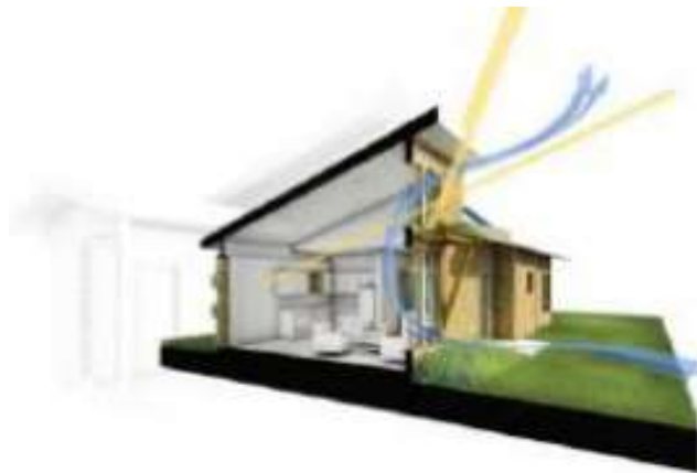
Ilustración 10: Circulación de las corrientes de aire.
