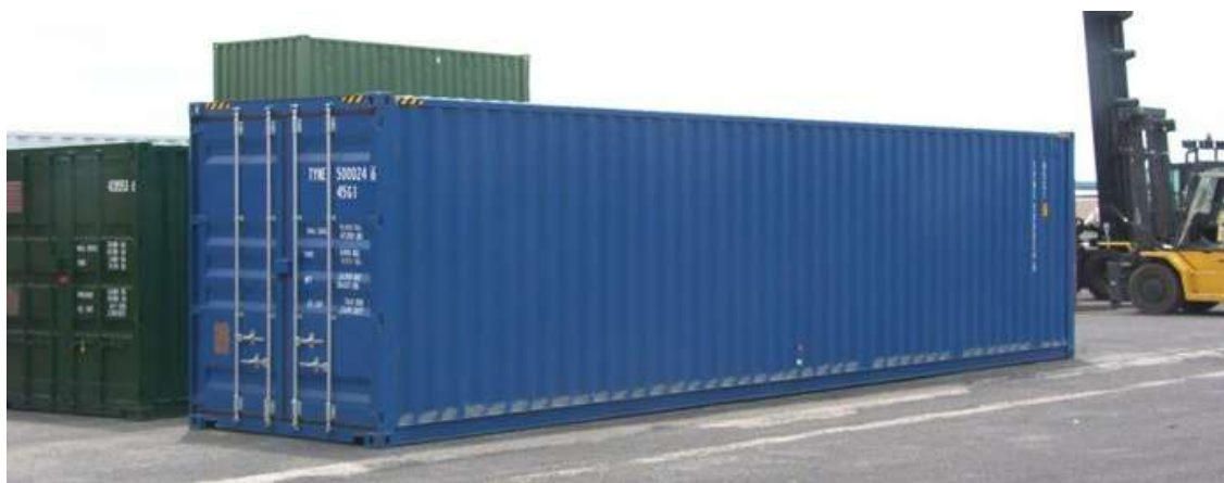
Ilustración 17: Contenedor high cube de 40 pies.
