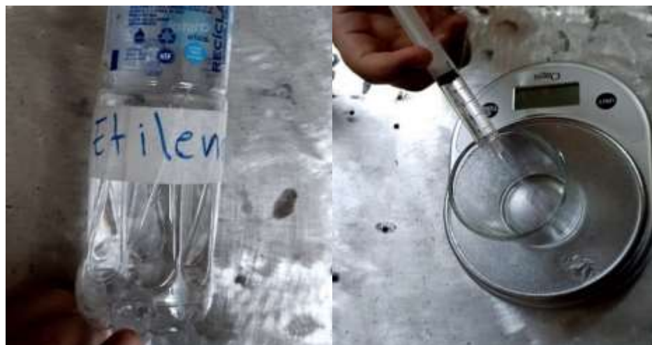
Figura 7. Medición de etileno utilizando una jeringa
