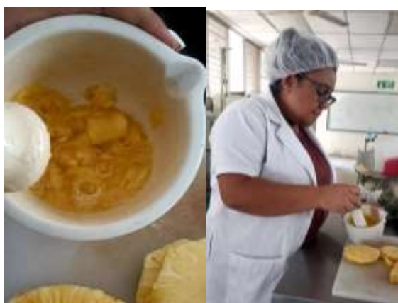
Figura 15. Medición de la variable de sólidos solubles totales
