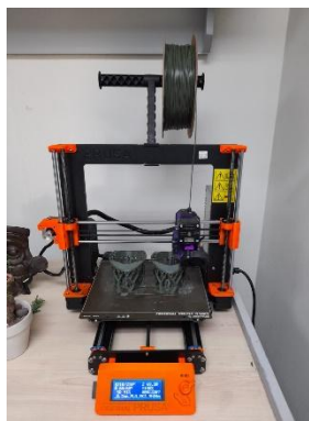
Anexo 37. Fotografía de Impresora 3D Prusa i3 MK3 imprimiendo una pieza en PLA del 3DLAB. Fuente: Elaboración propia.
