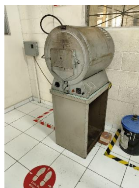
Anexo 24. Horno Heraeus para tratamientos térmicos de probetas y piezas de acero del CIDIM. Fuente: Elaboración propia.
