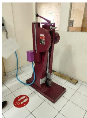
Anexo 23. Fotografía de máquina de ensayos de impacto (Charpy y con modificaciones puede ensayar Izod) del CIDIM. Fuente: Elaboración propia.
