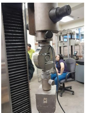
Anexo 35. Fotografía de acople de mordaza para identador del ensayo de flexión, del CEDITEC. Fuente: Elaboración propia.
