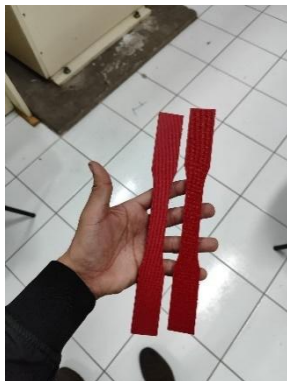
Anexo 16. Fotografía de probetas de TPU elaboradas para pruebas de caracterización de propiedades mecánicas según el patrón de relleno, CIDIM. Fuente: Elaboración propia.
