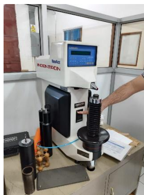
Anexo 22. Fotografía de equipo New Age para ensayos de dureza Rockwell del CIDIM. Fuente: Elaboración propia.
