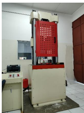
Anexo 18. Fotografía de la Máquina Universal de Ensayos del CIDIM, capacidad de 100 toneladas. Fuente: Elaboración propia.
