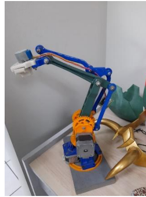
Anexo 45. Fotografía de brazo mecánico impreso en 3D en PLA, su aplicación requiere altos esfuerzos mecánicos en especial las piezas de transmisión de movimiento. Fuente: Elaboración propia.
