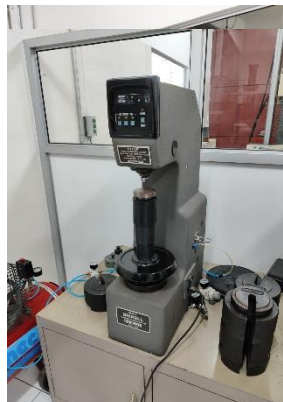
Anexo 20. Anexo 21. Fotografía de equipo Newags para ensayos de dureza (Brinell 2.5 y 5) del CIDIM. Fuente: Elaboración propia.
