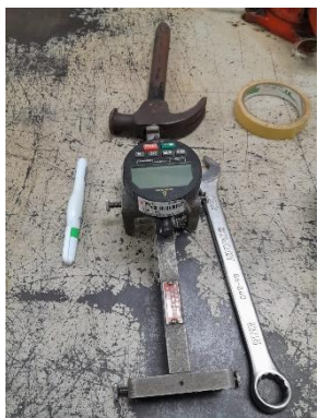
Anexo 33. Fotografía de extensómetro para ensayos de tensión del CEDITEC. Fuente: Elaboración propia.
