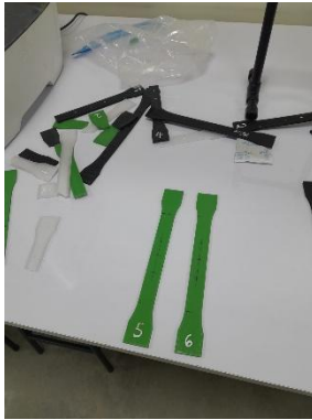
Anexo 41. Fotografía de probetas de PLA, elaboradas para pruebas de caracterización de propiedades mecánicas según el patrón de relleno, 3DLAB. Fuente: Elaboración propia.
