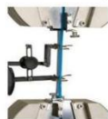
Figura 2. Correcta colocación del extensómetro en el espécimen de ensayo. Los extremos del extensómetro deben alinearse con las muescas en el espécimen que indican la longitud calibrada.
