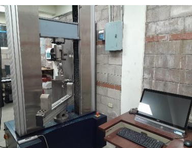
Anexo 36. Fotografía de accesorios de ensayo de flexión (Soportes e identador) del CEDITEC. Fuente: Elaboración propia.
