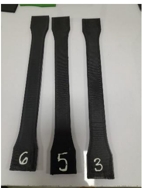
Anexo 28. Fotografía de probetas de TPU elaboradas para pruebas de caracterización de propiedades mecánicas según el patrón de relleno, CEDITEC. Fuente: Elaboración propia.
