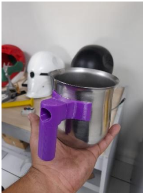
Anexo 42. Fotografía de pieza impresa en 3D en PLA, su aplicación requiere bajos esfuerzos mecánicos. Fuente: Elaboración propia.
