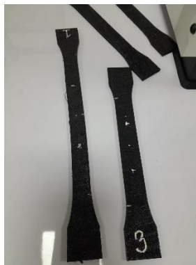
Anexo 29. Fotografía de probetas de TPU, una ensayada y la otra sin ensayar, notándose la deformación por esfuerzos axiales, CEDITEC. Fuente: Elaboración propia.
