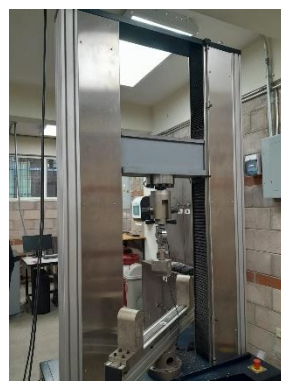
Anexo 32. Fotografía de Máquina Universal de Ensayos del CEDITEC, capacidad de 100 toneladas y con accesorios para ensayos de flexión, electrónica. Fuente: Elaboración propia.
