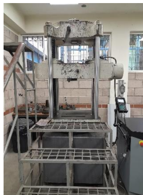
Anexo 31. Fotografía de Máquina Universal de Ensayos del CEDITEC, capacidad de 100 toneladas, electrohidráulica. Fuente: Elaboración propia.
