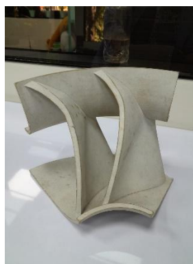
Anexo 30. Fotografía de prototipo de alabe de turbina Francis impresa en Resina con Polimerización VAT, en el CEDITEC. Fuente: Elaboración propia.
