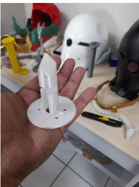
Anexo 44. Fotografía de pieza impresa en 3D en PLA, su aplicación requiere altos esfuerzos mecánicos. Fuente: Elaboración propia.
