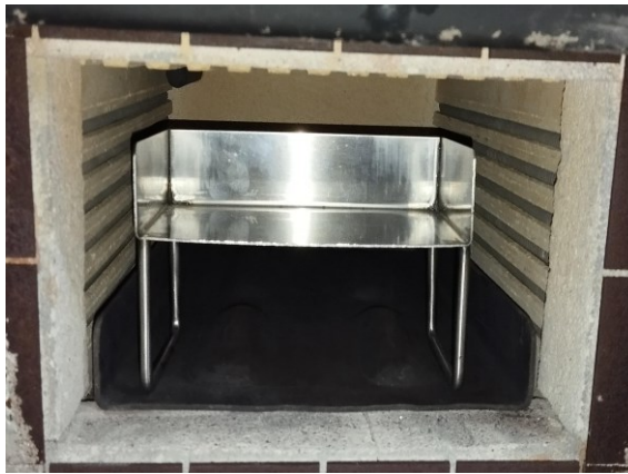
Ilustración 64 Soporte ubicado en cámara de horno de tratamientos térmicos de la Universidad de El Salvador.
