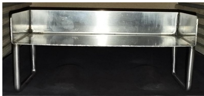
Ilustración 51 Soporte construido con acero AISI 304.
