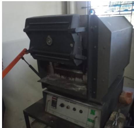
Ilustración 65 Cierre de compuerta de horno de tratamientos térmicos.
