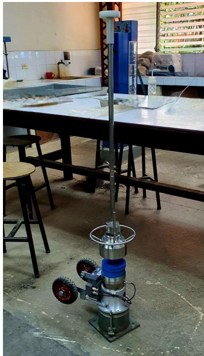
Figura 5.1.6.1-2 Posicionamiento LWD en molde Proctor en laboratorio.
