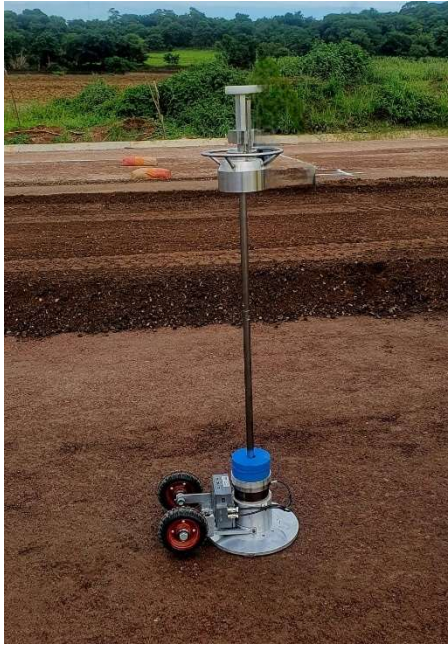
Figura 5.1.5-1 Equipo LWD según ASTM E 2583.
