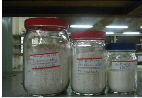
Figura N° 40: Almidón sin modificar y pregelatinizado de raíz de Sechium edule y almidón comercial Starch 1500®
