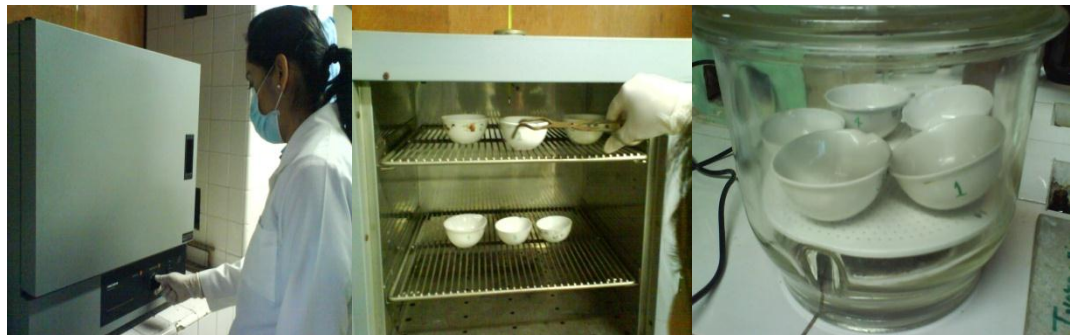
Figura N° 48: Prueba de Pérdida por secado
