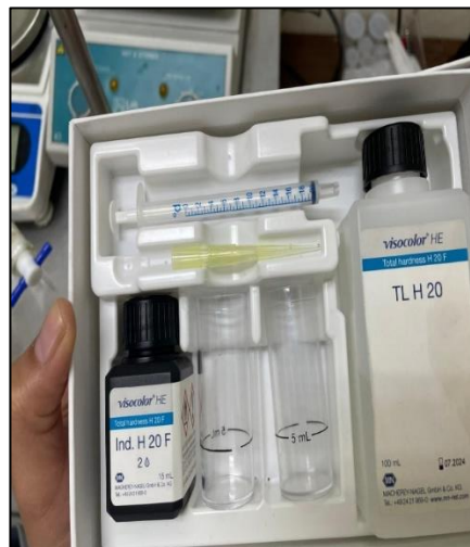
Figura 9. Test para determinar dureza del agua
