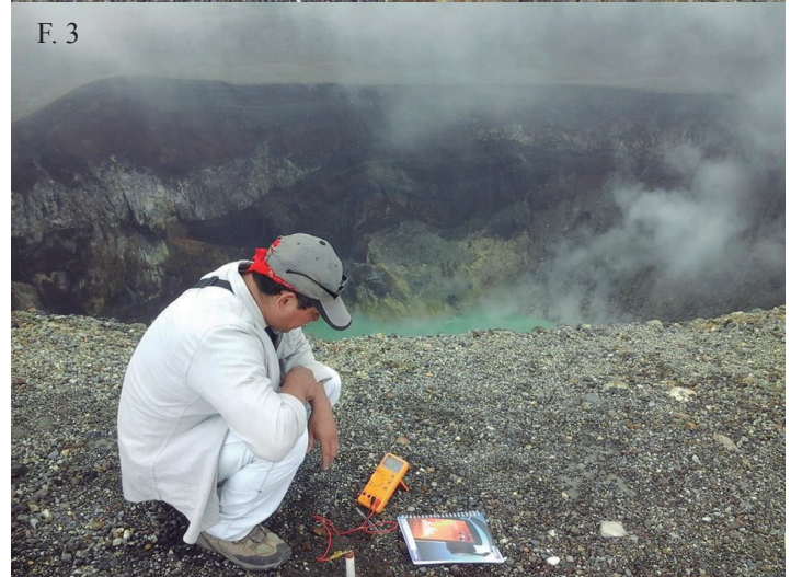
F. 1, F. 2, F. 3. Grupo de investigación del GIV-UES, llevan a cabo la técnica cromatográfica que consiste en la toma de datos para la obtención de gases y fluidos ácidos que pueden emanar del suelo de la parte alta del cráter del volcán. >
