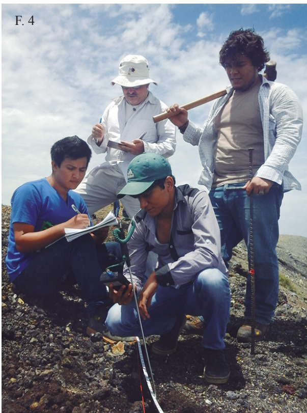
◀ F. 4, F. 5. Lic. Benancio Henríquez emplea junto a sus alumnos la técnica de medición de temperatura de suelo lo cual sirve para medir la cercanía de un cuerpo caliente que, por lo general pretende saber si una cámara magmática muy activa es capaz de emitir calor a la superficie del volcán Santa Ana.
