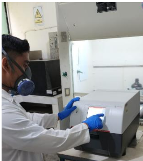
Figura 37. Establecimiento de las condiciones EPA 3052 en microondas.
