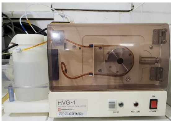
Figura 39. Módulo Generador de Hidruros HVG-1 marca Shimadzu utilizado para el análisis de Arsénico.
