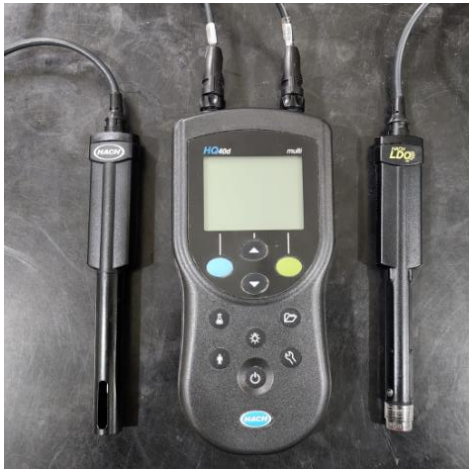
Figura 9. Sonda multiparámetros Hach HQ 40d.
