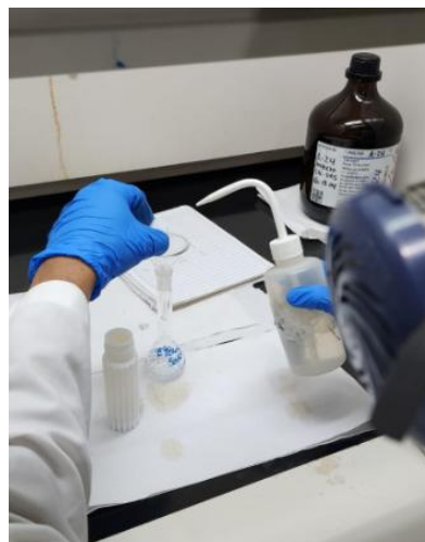
Figura 34. Incorporación de muestra de sedimento digerida en balón volumétrico de 50.0mL.
