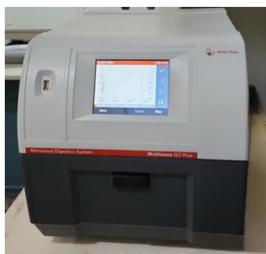
Figura 32. Sistema de Digestión Microondas Multiwave GO Plus marca Anton Paar utilizado para las digestiones de las muestras
