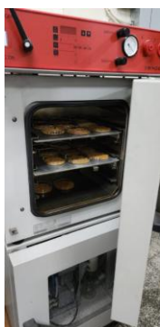
Figura 26. Proceso de secado de músculo de tilapia en estufa de vacío.
