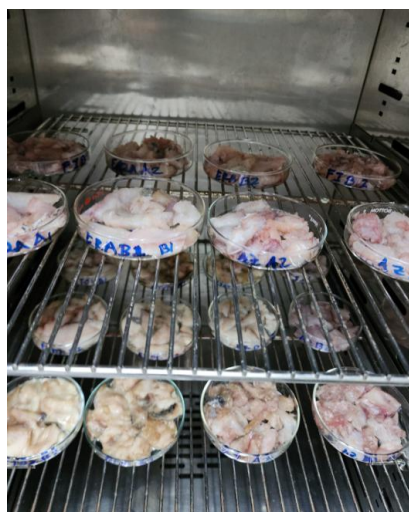
Figura 24. Proceso de secado de músculo de tilapia en estufa de aire circulante.
