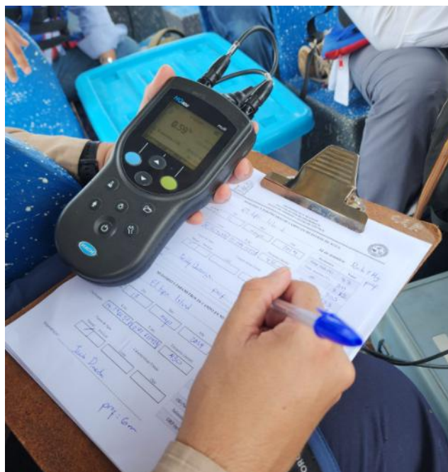
Figura 8. Toma y registro de parámetros fisicoquímicos en muestras de agua superficial y a profundidad
