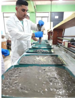
Figura 16. Incorporación de muestras a bandejas plásticas.
