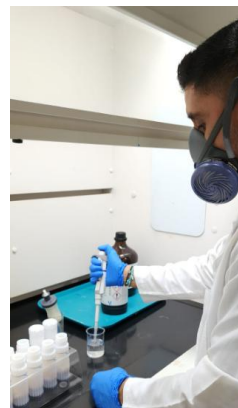
Figura 36. Adición de peróxido de hidrógeno.
