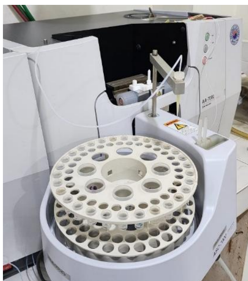
Figura 38. Equipo Espectrofotómetro de absorción atómica, Módulo Horno de Grafito marca Shimadzu AA-700 para determinación de Cd, Cr, y Pb.
