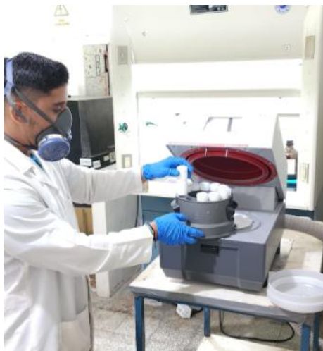
Figura 33. Incorporación de muestras al microondas para proceso de digestión
