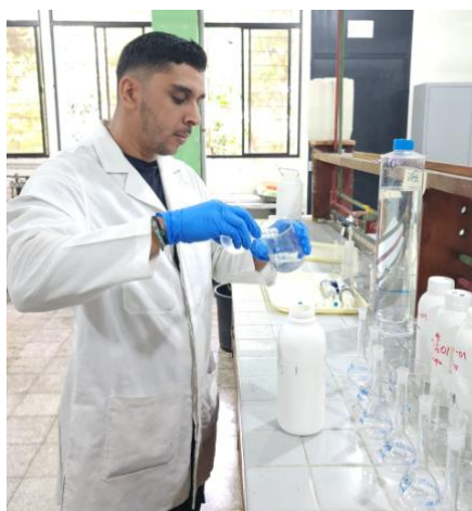
Figura 28. Toma de muestra de agua para digestión.
