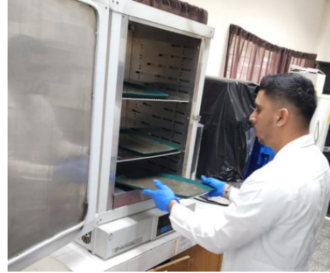
Figura 17. Proceso de secado de muestras de sedimento en estufa de aire circulante.
