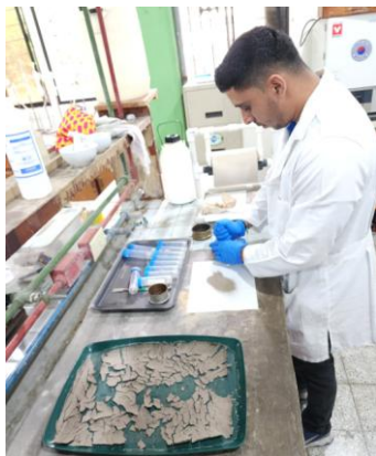
Figura 18. Proceso de trituración y tamizado de muestras de sedimento
