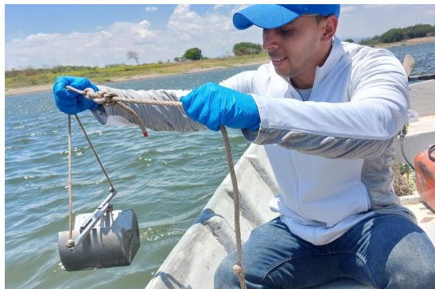
Figura 11. Colecta de muestras de sedimento utilizando draga Fieldmaster Mighty Grab marca Wildco.
