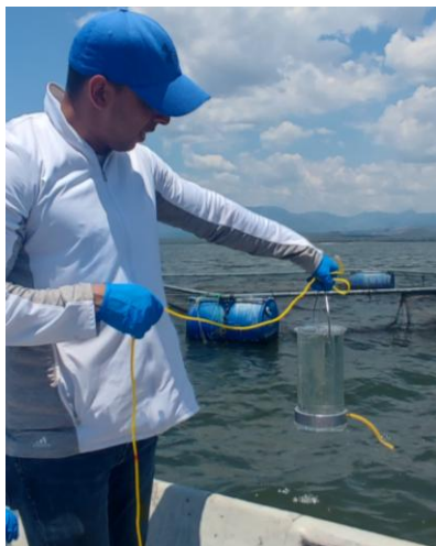
Figura 7. Colecta de muestra de agua superficial y a profundidad.
