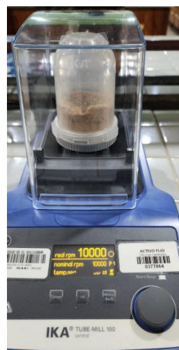
Figura 25. Molino Ika TUBE-MILL 100, utilizado para triturar las muestras de tilapia.
