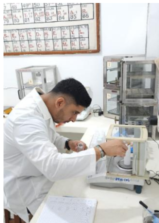
Figura 35. Pesaje de muestras de tilapia para digestión en tubos de teflón.
