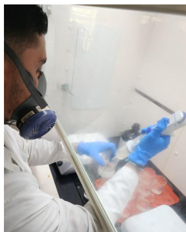
Figura 29. Adición de \text{HNO}_3 concentrado a las muestras de agua.
