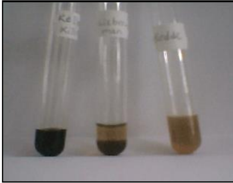
Figura No. 9. Pruebas de identificación de Glicósidos Cardiónicos: Keller-killiani, Liebermann-Burchard y Kedde
