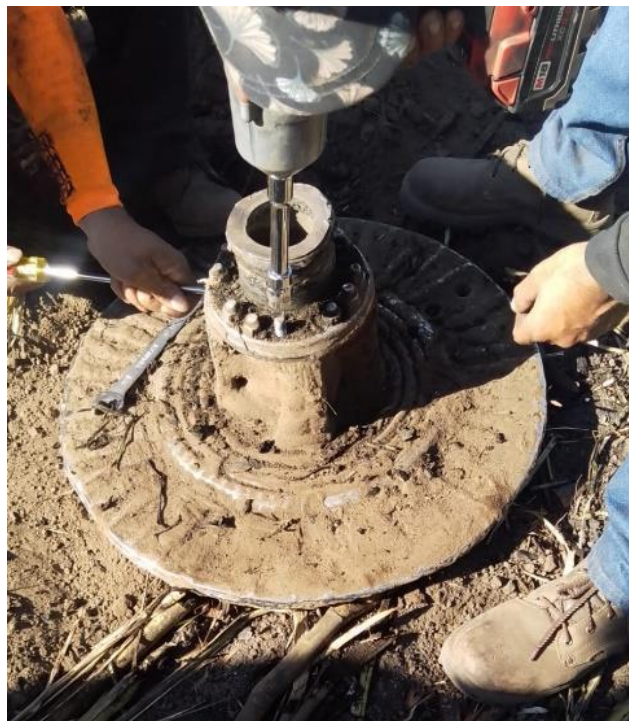
Anexo 9. Ejemplo de falla en fusible de base cortadora, sistema de corte base. Falla de base cortadora ocurrida el día 27/02/23, cosechadora CH570 código 7300001588, Hacienda Santa Teresa, Cara Sucia, Ahuachapán.
