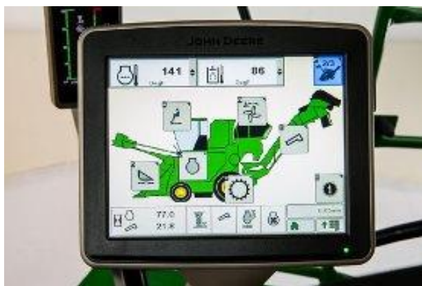
Anexo 17. Interfaz de operación en cabina de conducción de una cosechadora de caña John Deere CH570.
