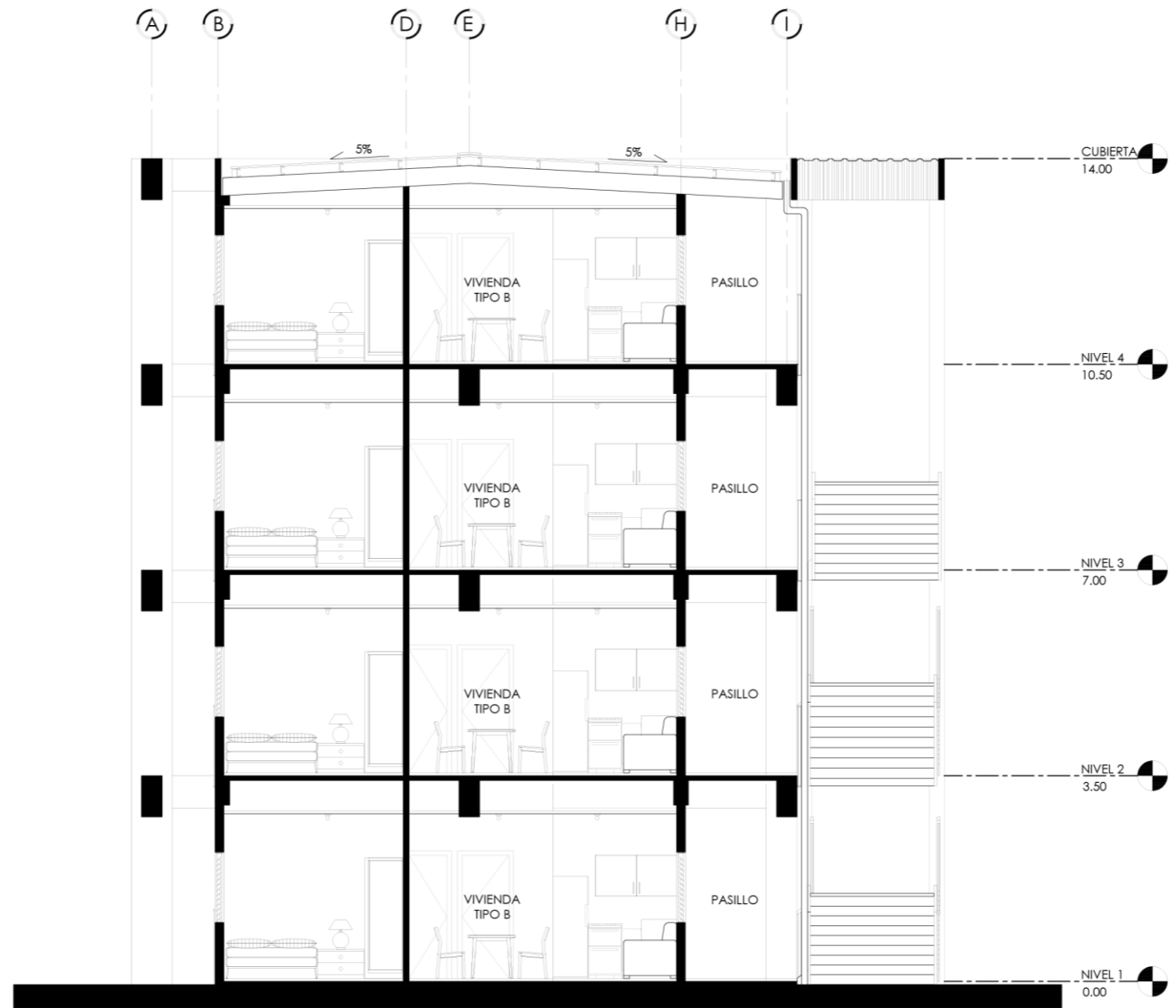
CORTE TRANSVERSAL D-D' VIVIENDA TIPO "B" ESCALA 1:100
