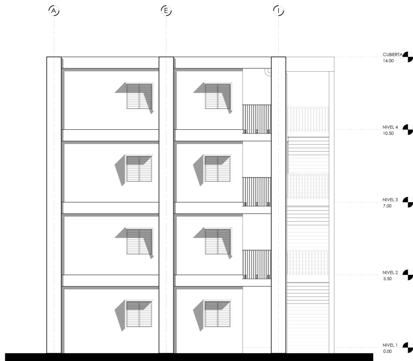
FACHADA LATERAL ESTE-OESTE EDIFICIO DE VIVIENDA ESCALA 1:100
